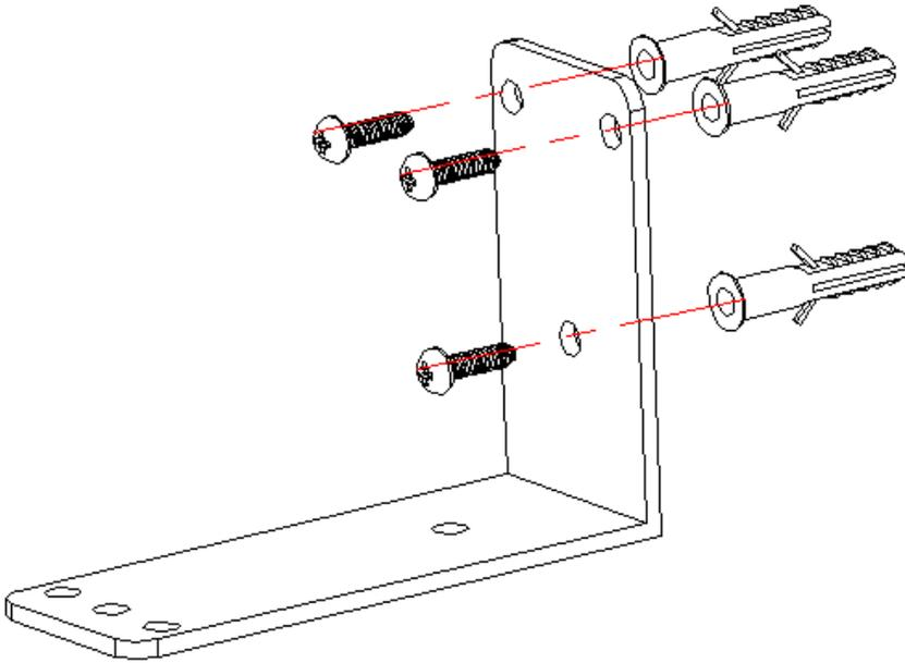
Stap 4: Bestig nu het apparaat aan de muurbeugel met behulp van de vleugelmoeren en schroeven (2,3). Draai alles goed aan. Zet het apparaat vervolgens in de juiste hoek en draai de moer (1) vast met de inbussleutel (4).
