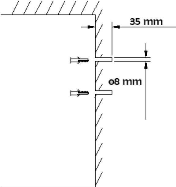
Schritt 3: Befestigen Sie die Wandhalterung mit den Schrauben an der Wand.
