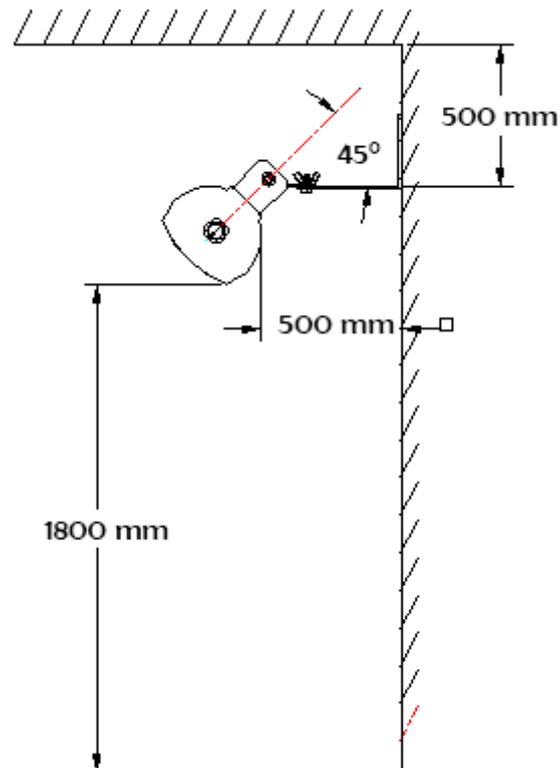
Zorg ervoor dat de muur waarop het toestel gemonteerd is niet gemaakt is van brandbare materialen (zoals bv. hout). Controleer de buitenmuren op communicatie- en elektriciteitskabels en leidingen. Indien er kabels of leidingen in de directe omgeving aanwezig zijn, installeer het toestel op een andere plaats.
