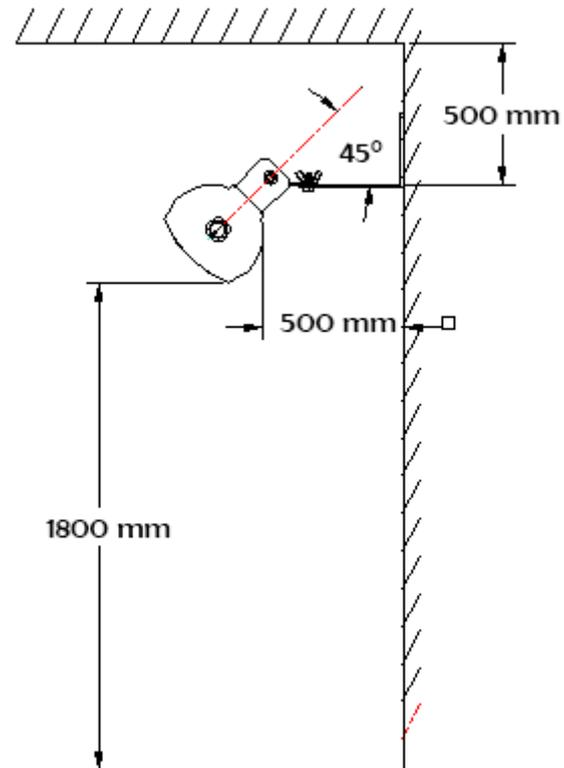
Assurez-vous que le mur sur lequel vous voulez monter l'appareil n'est pas composé de matériaux inflammables (le bois, par exemple). Vérifiez les murs extérieurs afin de détecter les câbles et canalisations de télécommunications et d'électricité. Si des branchements se trouvent dans les environs immédiats, n'installez pas l'appareil de chauffage à cet endroit et trouvez un autre endroit.
