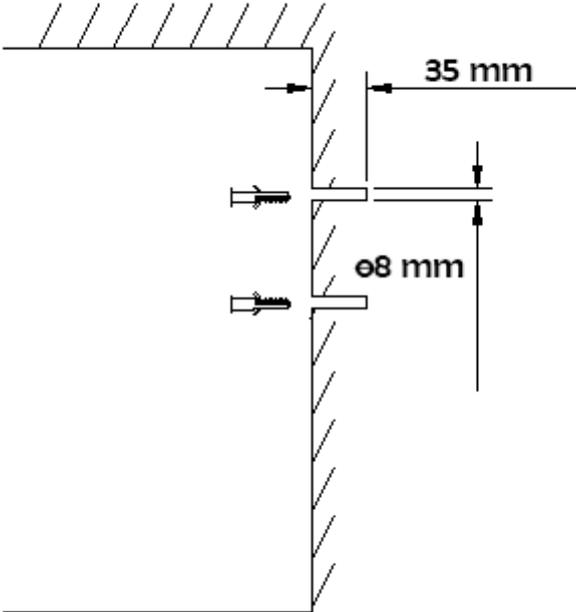
Paso 3: Fije el soporte de pared a la pared con los tornillos.
