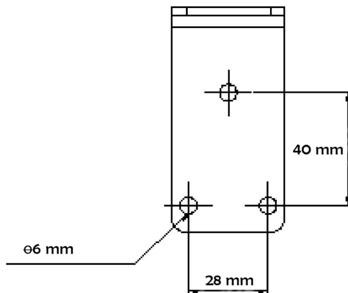
Schritt 2: Stecken Sie die 3 Dübel in die Wand.
