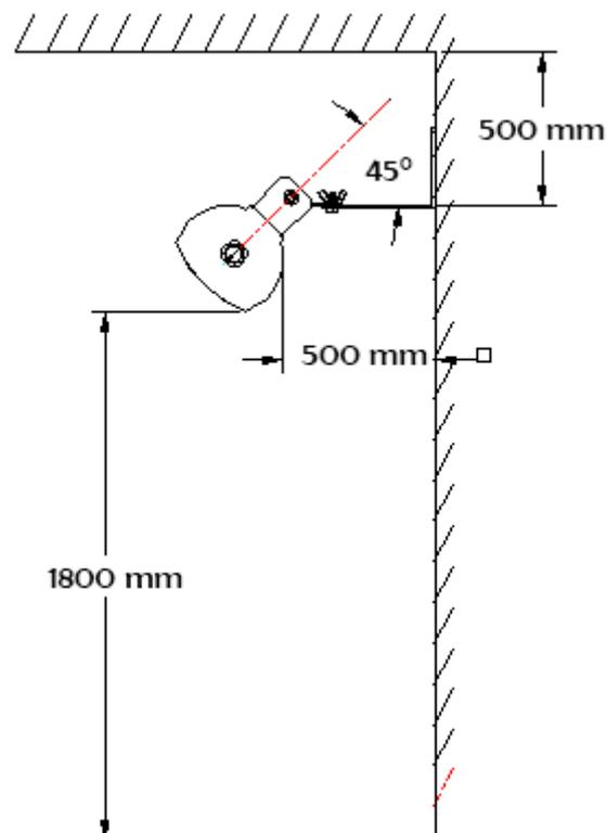
Asegúrese de que la pared de montaje no esté hecha de materiales combustibles (por ejemplo, madera). Revise las paredes exteriores en busca de cables y tuberías de comunicación y eléctricas. Si hubiera cables de servicio en las inmediaciones, no instale el calentador allí y busque una ubicación alternativa.
