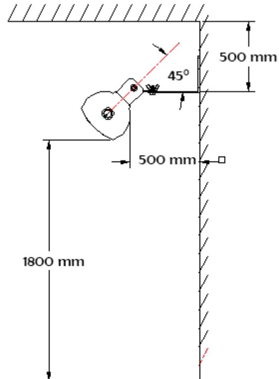
Stellen Sie sicher, dass die Montagewand nicht aus brennbaren Materialien (z.B. Holz) besteht. Prüfen Sie die Außenwände auf eventuell vorhandene Kommunikations- und Elektrokabel sowie Rohrleitungen. Sollten in unmittelbarer Nähe Versorgungsleitungen vorhanden sein, installieren Sie das Heizgerät nicht, sondern suchen Sie nach einem anderen Installationsort.
