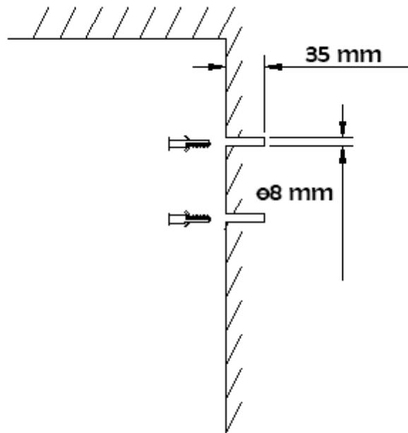
Stap 3: Bevestig de muurbeugel aan de muur met behulp van de schroeven.
