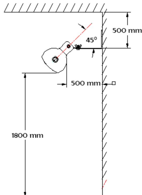
Upewnić się, że ściana montażowa nie jest wykonana z materiałów łatwopalnych (np. drewna). Sprawdzić, czy w ścianach zewnętrznych nie ma kabli komunikacyjnych, elektrycznych ani rurociągów.
