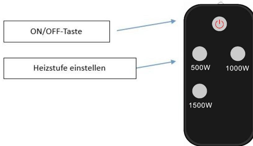
1. ON/OFF-Taste: Schaltet das Gerät ein oder aus
